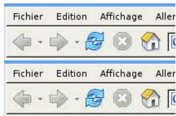
Figure 4 : exemples de compression PNG (faible) et JPEG (forte) avec la barre d'outils FIREFOX (des artefacts de compression apparaissent avec JPEG)
