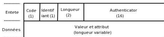
Figure 2 : Structure d'un paquet de données RADIUS
